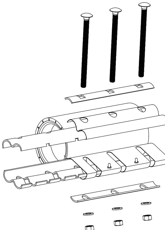
Вставная планка накидной стороны имеет прорези. Болты вставляются в прижимную пластину с квадратными отверстиями, затем в замковое соединение со стороны противоположной накидной, затем на болты одевается прижимная пластина с круглыми отверстиями, шайбы и гайки.
