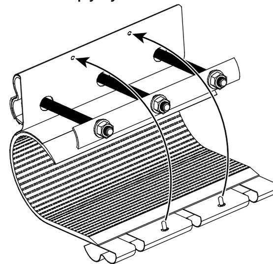
**!** Следите за попаданием направляющих в предназначенные для них отверстия
