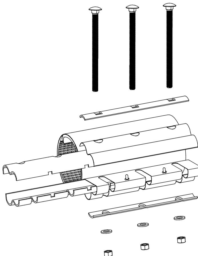
Вставная планка накидной стороны имеет прорези. Болты вставляются в прижимную пластину с квадратными отверстиями, затем в замковое соединение со стороны противоположной накидной, затем на болты одевается прижимная пластина с круглыми отверстиями, шайбы и гайки.
